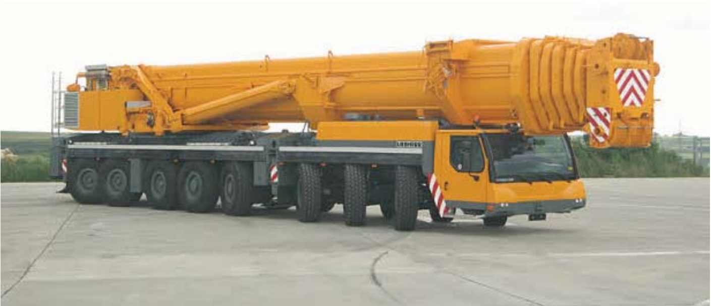
Kuva 12. Liebherr LTM 1500-8.1 -ajoneuvonosturi (Liebherr 2012a).
